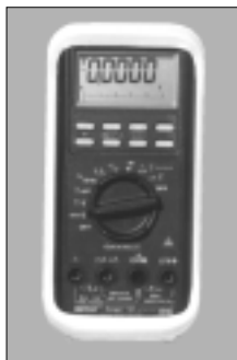
Obr. 2. Digitální multimetr Hexagon 720 s rozhraním IR-RS-232
