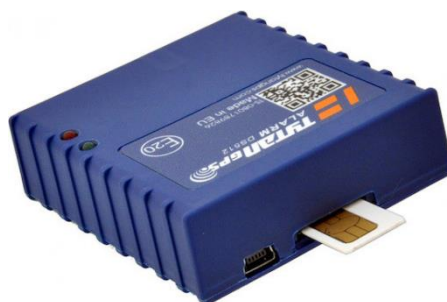
Obrázek 16 Externí GSM jednotka pro dvoucestné EZA
