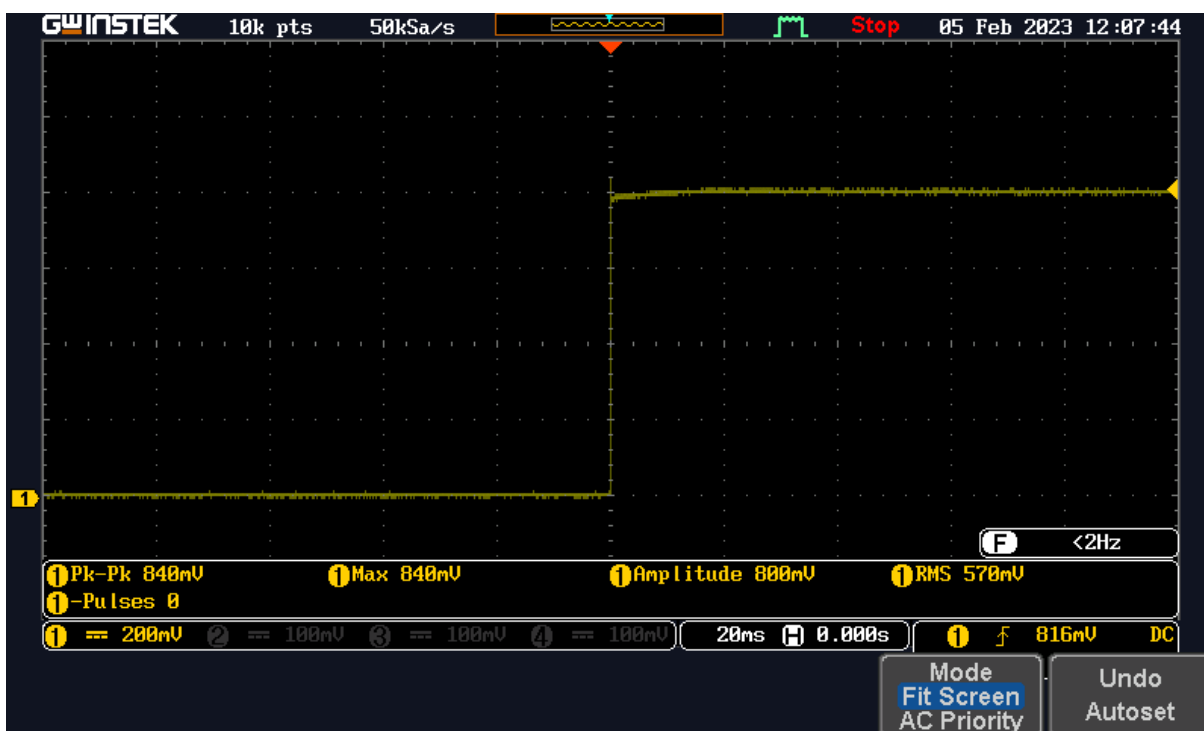
Obrázek 24 Měření napěťových změn - zastřeženo, poplach
