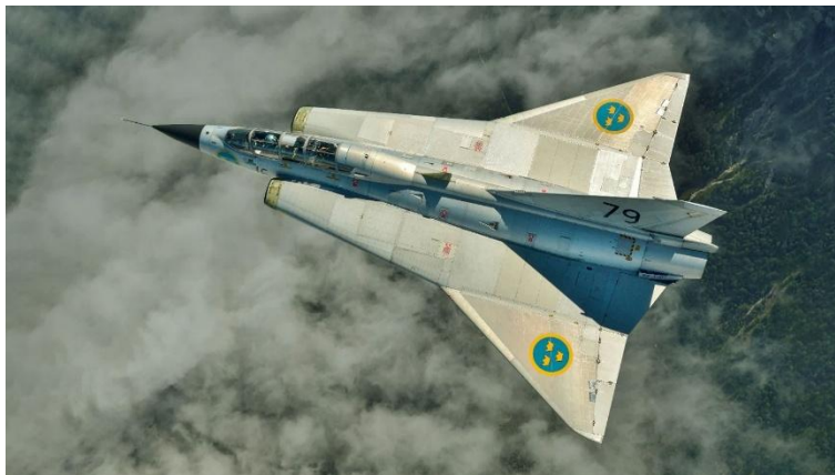
Obrázek 16: Složená delta u Saab J35 Draken
