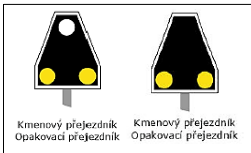
Obrázek 9 - Návěsti kmenového i opakovacího návěstidla přejezdník
