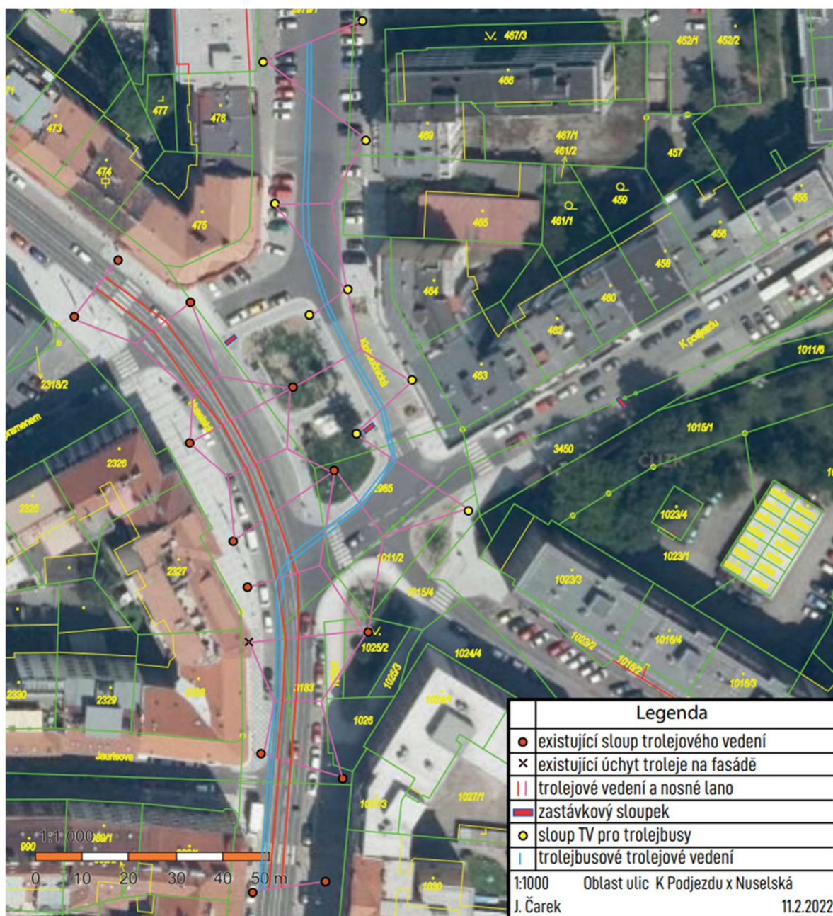
Příloha 4: Návrh trolejového vedení v oblasti Nuselská
