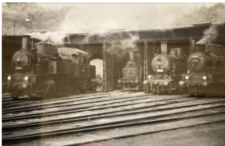
Obrázek 32, zajímavé období provozu v Lužné, kdy se provádělo zbrojení lokomotiv mazutem, na snímku můžeme vidět cisternu s ním, kterou bylo potřeba vytápět (3.9.1967)
