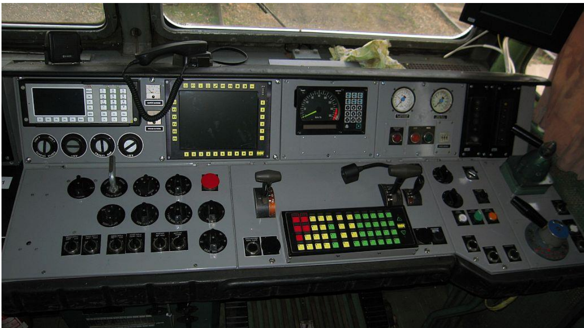
Obrázek 12: Pult lokomotivy 362 166-1 vybavené ETCS
